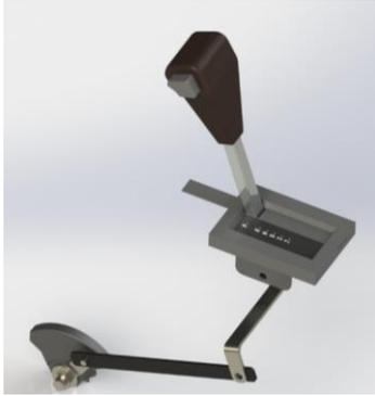
Figura 2. Adaptación de la palanca selectora de marchas.
