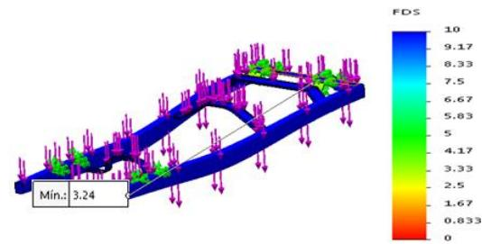
**Figura. 5.** Factor de seguridad.
