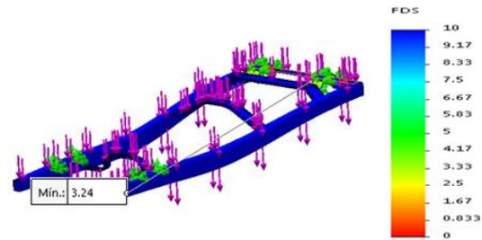
Figura. 5. Factor de seguridad.
