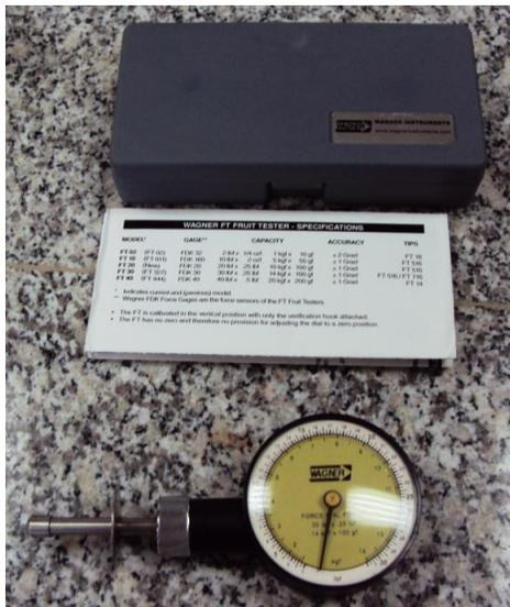
Figura 5. Penetrómetro.
