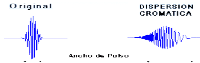
Figura 9. Pulso que viaja en la fibra con dispersión cromática
