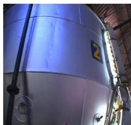
**Figura 9.** Tacho de Cocción (Cristalización)
