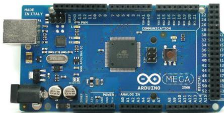
Fig. 2. Arduino Mega 2560.
