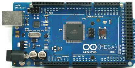
Fig. 2. Arduino Mega 2560.
