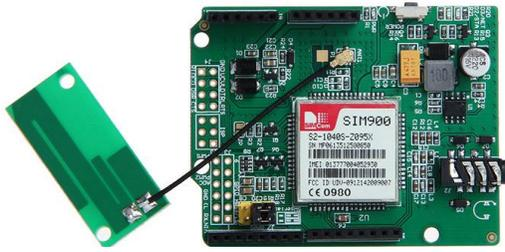
Fig. 12. GPRS/GSM Shield v2 SIM900 module.
