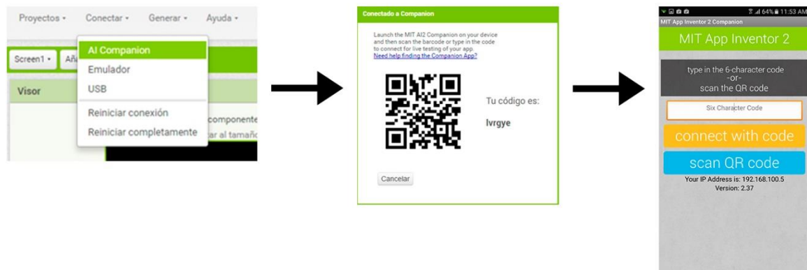
FIGURA 93. PROCESO DE CONEXIÓN ENTRE MIT AI2 COMPANION Y APP INVENTOR. FUENTE: CRITERIOS DE DISEÑO DEL PROYECTO.
