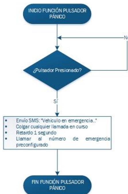
FIGURA 50. DIAGRAMA DE FLUJO DE LA FUNCIÓN PULSADOR PÁNICO.
