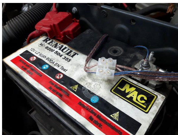
FIGURA 111. TOMA DE ALIMENTACIÓN PRINCIPAL DEL PROTOTIPO. FUENTE: CRITERIOS DE DISEÑO DEL PROYECTO.
