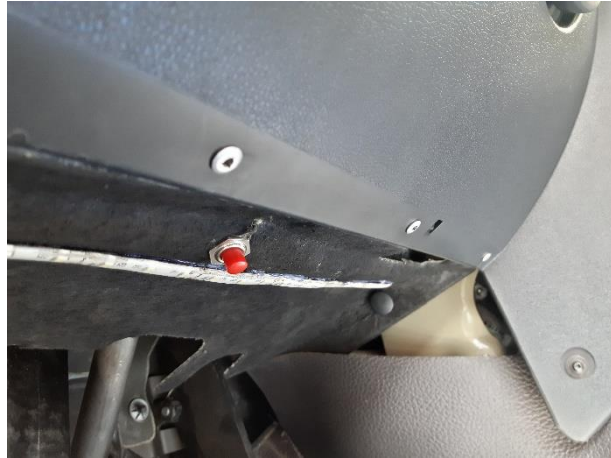
FIGURA 114. INSTALACIÓN DEL BOTÓN DE PÁNICO EN EL INTERIOR DEL VEHÍCULO.
