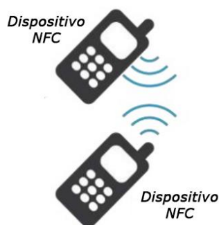
FIGURA 16. EJEMPLO MODO PEER TO PEER NFC. FUENTE: CRITERIOS DE DISEÑO DEL PROYECTO.
