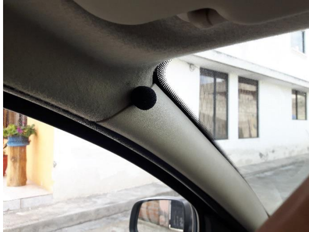
FIGURA 112. MICRÓFONO INSTALADO EN EL INTERIOR DEL VEHÍCULO. FUENTE: CRITERIOS DE DISEÑO DEL PROYECTO.
