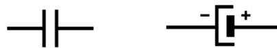
FIGURA 26. SÍMBOLO DEL CONDENSADOR FIJO Y ELECTROLÍTICO RESPECTIVAMENTE. FUENTE: INTEF (2016). ELECTRÓNICA ANALÓGICA . RECUPERADO DE: HTTPS://GOO.GL/WLVNTZ
