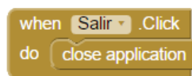
FIGURA 104. PROGRAMACIÓN EN BLOQUES DEL BOTÓN SALIR DE LA SCREEN2. FUENTE: MIT APP INVENTOR (2016). MIT APP INVENTOR 2 BETA . RECUPERADO DE: HTTP://AI2.APPINVENTOR.MIT.EDU/?LOCALE=ES_ES#4898379748605952
