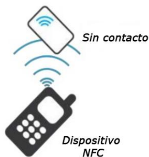
FIGURA 15. EJEMPLO MODO LECTOR/GRABADOR NFC. FUENTE: CRITERIOS DE DISEÑO DEL PROYECTO.
