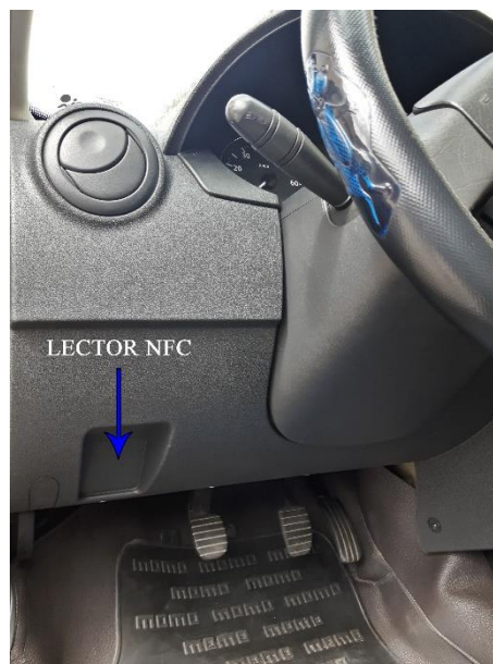
FIGURA 113. LECTOR NFC INSTALADO EN EL INTERIOR DEL VEHÍCULO. FUENTE: CRITERIOS DE DISEÑO DEL PROYECTO.
