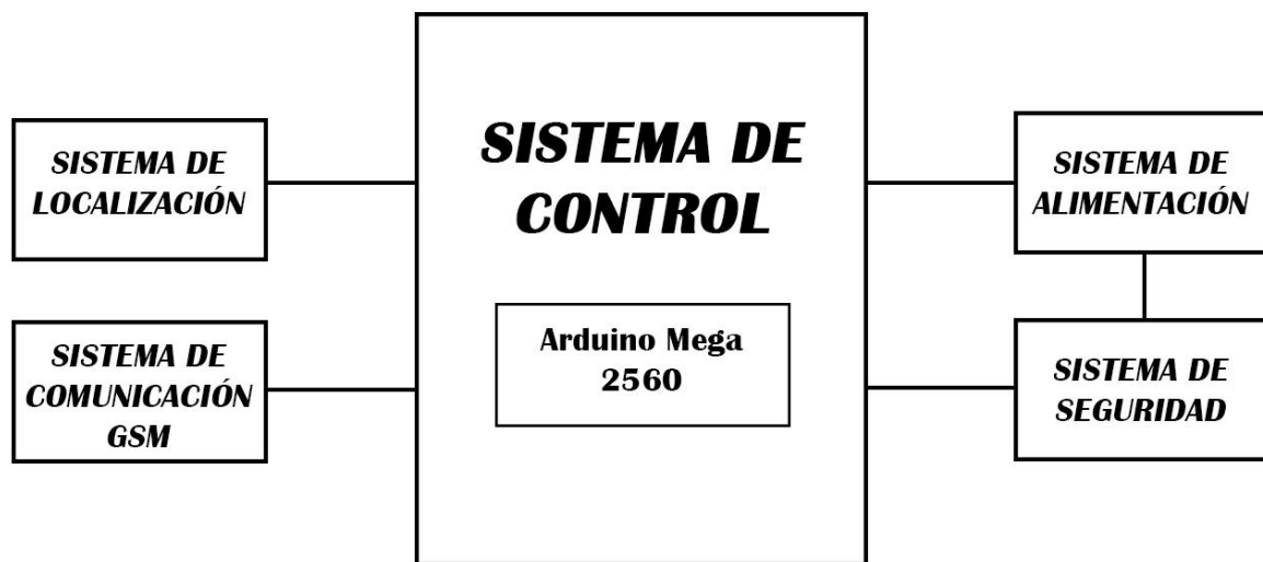
FIGURA 35. DIAGRAMA DE BLOQUES DEL SISTEMA DE CONTROL.
