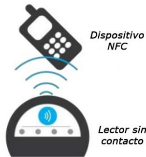
FIGURA 17. EJEMPLO MODO EMULACIÓN DE TARJETA INTELIGENTE NFC.
