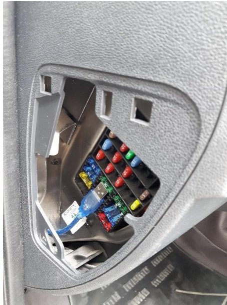
FIGURA 115. INSTALACIÓN DEL CABLE USB EN EL INTERIOR DEL VEHÍCULO.
