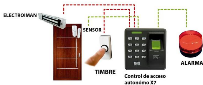
Figura 34. Sistema de control de acceso
