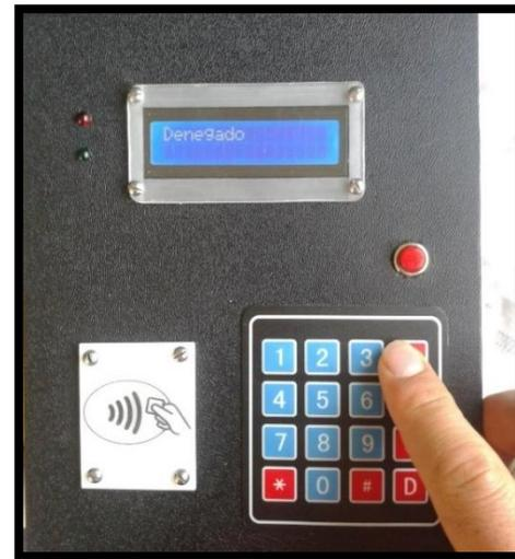
Fig. 19: Ingreso de clave incorrecta mediante teclado matricial.
