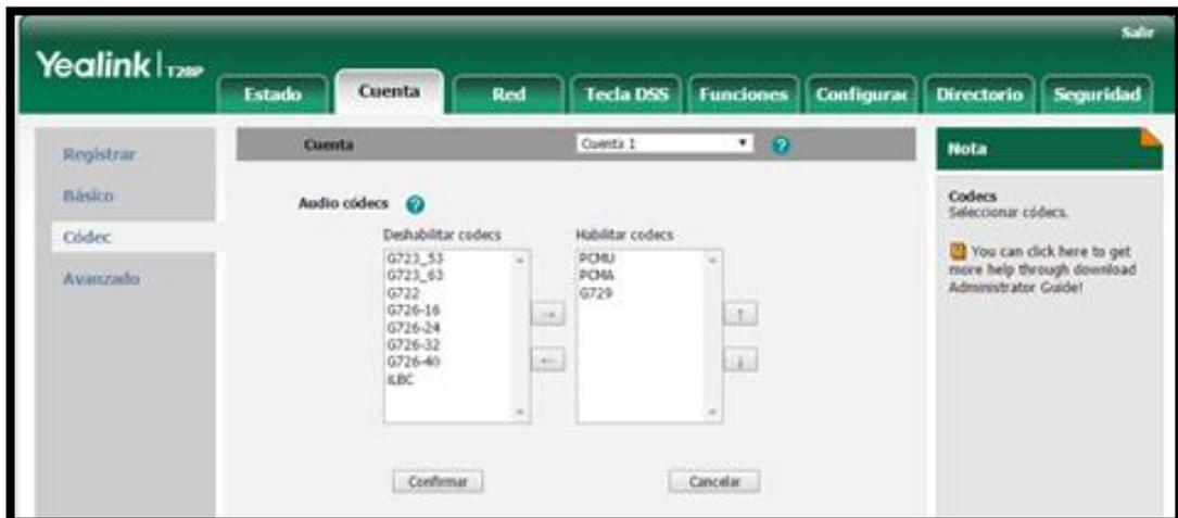
**Figura 23.** Codecs de voz del SIP-T28P
