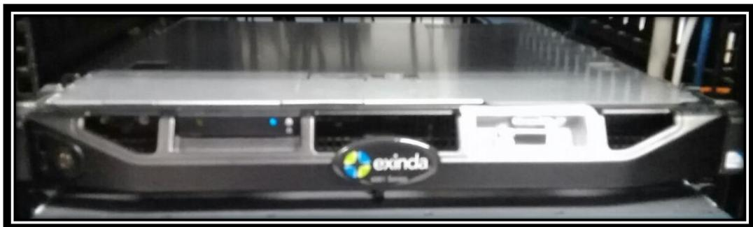
**Figura 16.** Controlador de ancho de banda Exinda 4761
