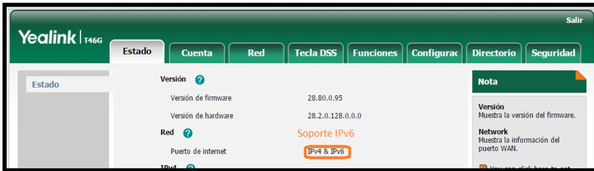
**Figura 20.** Soporte IPv6 del SIP-T46G
