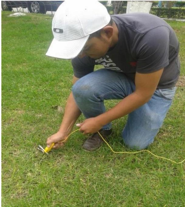
**FIGURA 34:** Medición de resistividad postgrado
