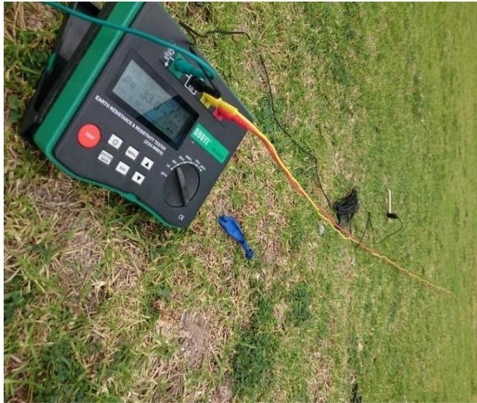
**FIGURA 36:** Medición de resistividad piscina
