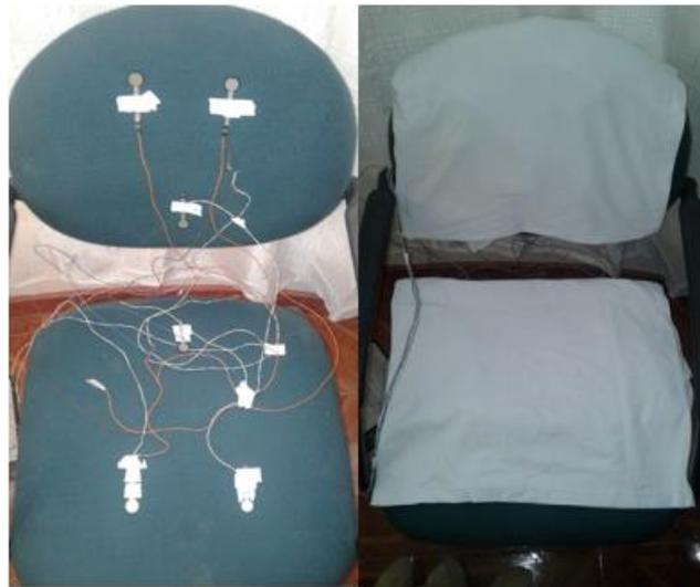
*Figura 33: Ubicación y Prueba de Sensores en Primer Prototipo*
