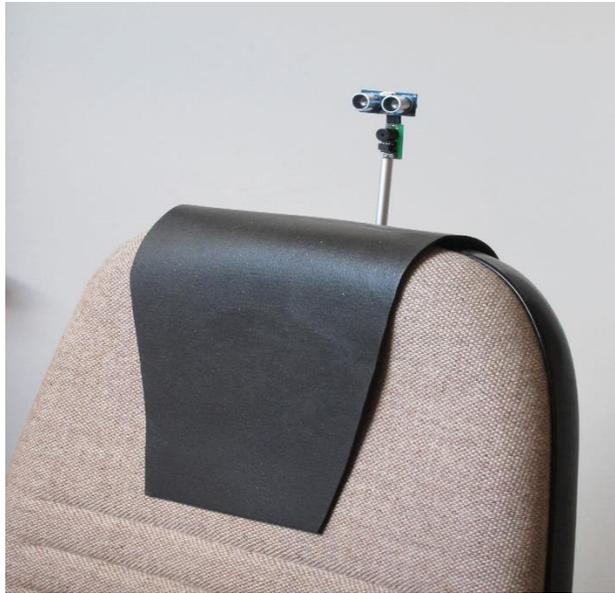
*Figura 7: Sistema de sensado por medio de un sensor de distancia.*
