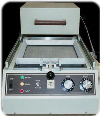
Figura 6. Máquina Termo Formado.
