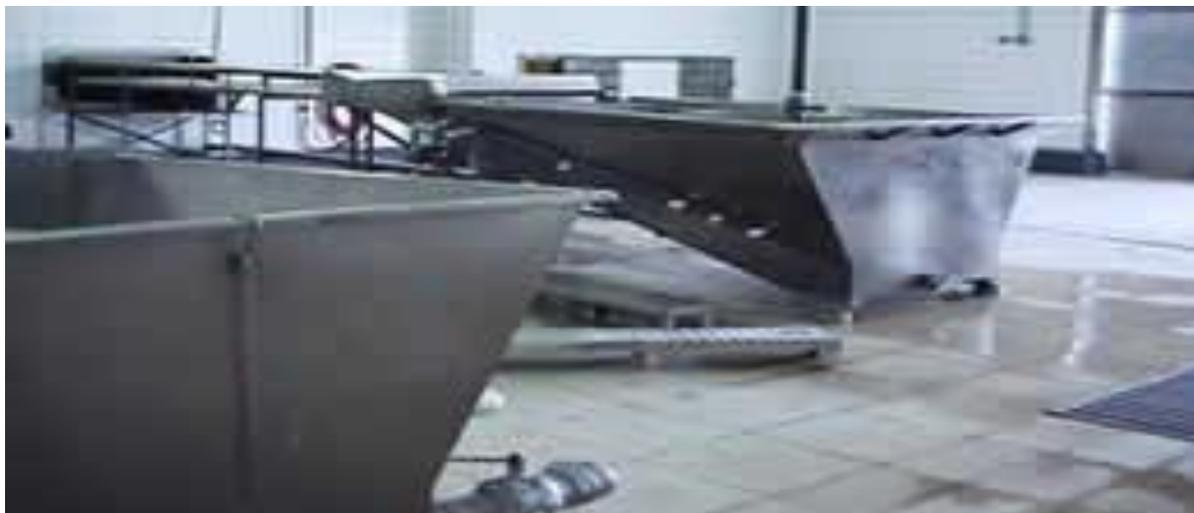
**Ilustración 12** Tanque de recepción y lavado
