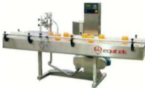
**Ilustración 15 envasadora y etiquetadora**
