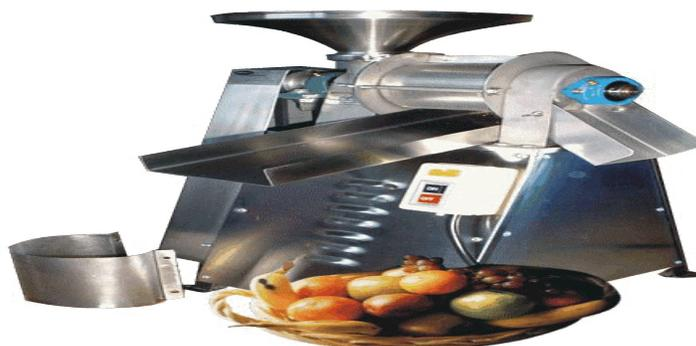
**Ilustración 7** Despulpadora de guayaba
