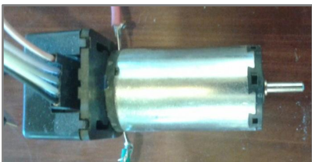
Figura 2: Motor DC maxon A-max Brushes con encoder HEDS 5540.
