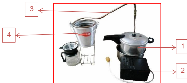
Figura 4. Destilador de agua portátil; 1- Caldera; 2- Circuito de control; 3- Tubería; y 4- Recipiente de destilación.
