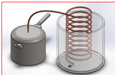
Figura 1. Boceto del diseño del destilador de agua.
