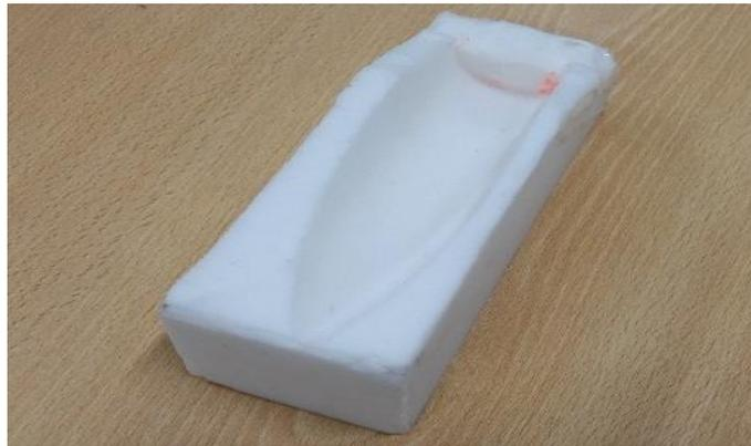
*Figura 56. Molde de la tapa Cabina*
