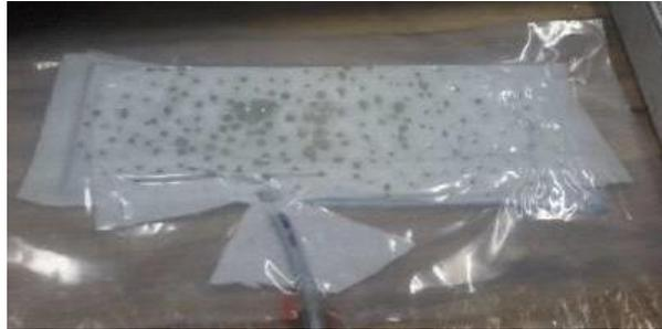
*Figura 37. Puesta a vacío*
