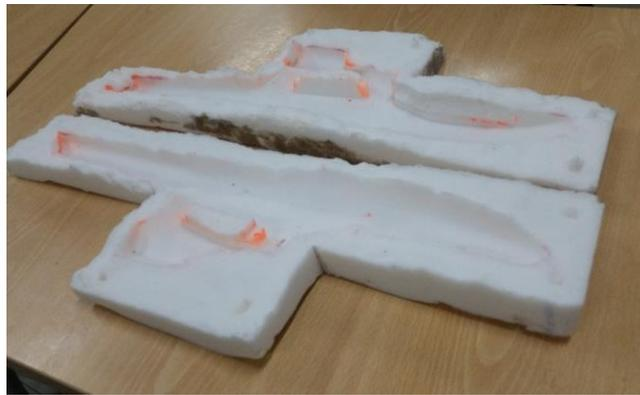
*Figura 53. Molde del Fuselaje.*
