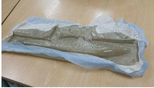
*Figura 58. Fuselaje con material compuesto*
