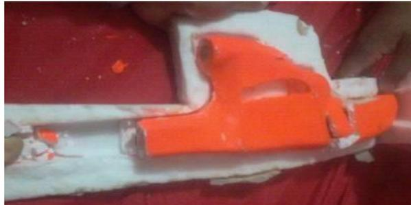
*Figura 31. Mitad desmoldada del fuselaje.*
