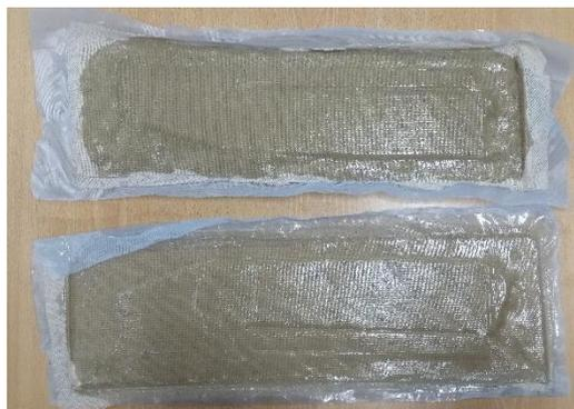
*Figura 57. Alas en material compuesto*
