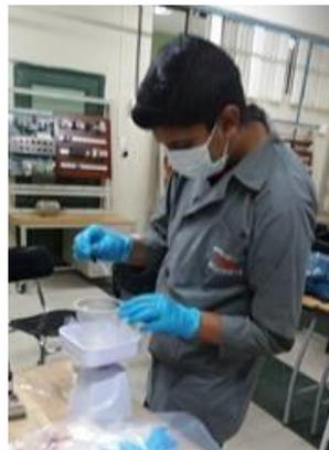
*Figura 32. Medición de las cantidades de catalizador y acelerante*
