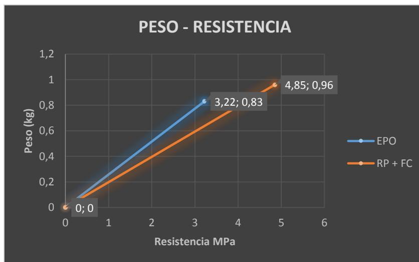
Figura 46. Comparación relación peso - resistencia de los dos materiales.
