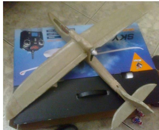
Figura 7. Dron ensamblado con material compuesto
