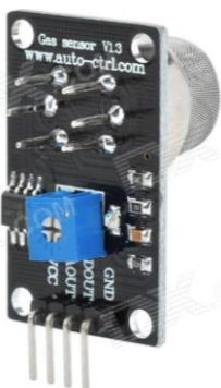
Ilustración 19 Sensor MQ2 montado en una placa comercial (breakout board)
