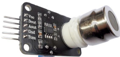
Ilustración 11 Sensor MG-811 montado en una placa comercial (breakout board)
