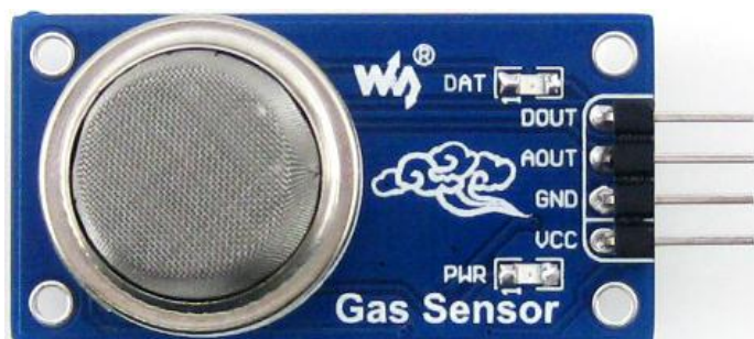
Ilustración 13 Sensor MQ135 montado en una placa comercial (breakout board)
