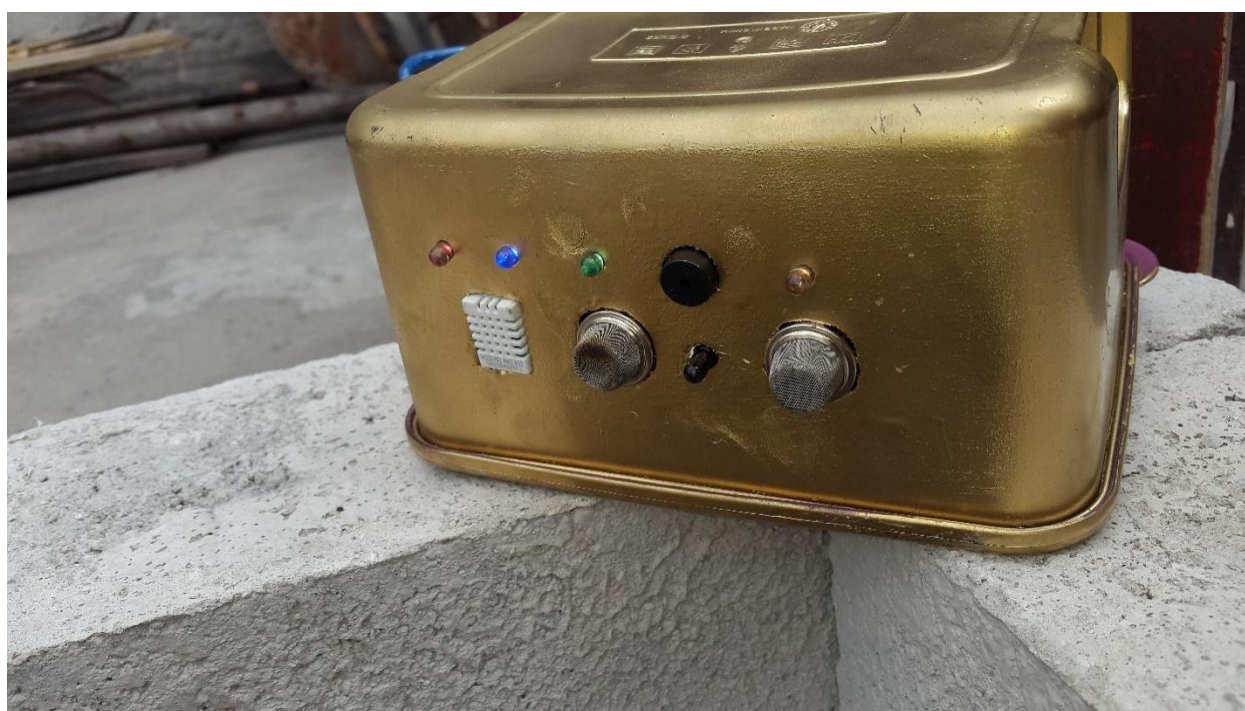
Ilustración 74 Prototipo del sistema multisensor alertando de un incendio.
