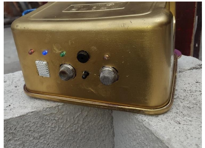
Figura 18. Prototipo del sistema multisensor alertando de un incendio. Fuente: Desarrollo del proyecto.
