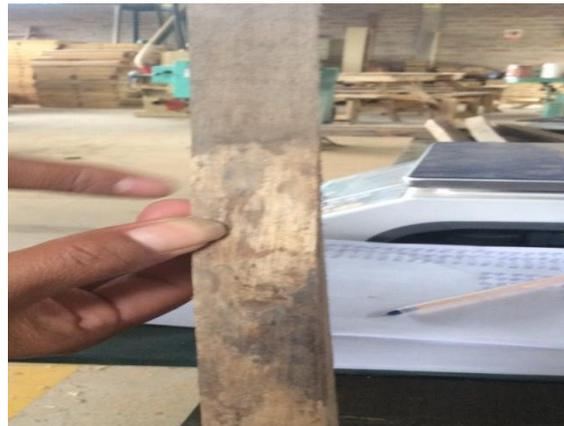
**Ilustración 21.** Daños en probeta
