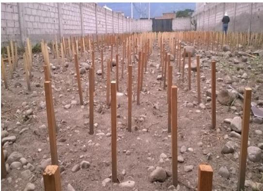
**Ilustración 17.** Ensayo de cementerio
