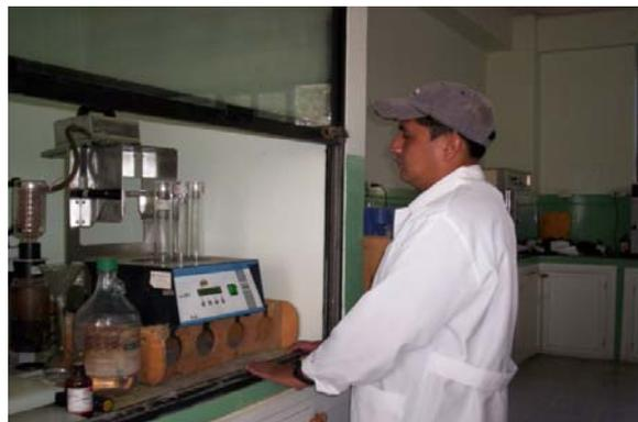
Equipo digestor Kjeldhal para determinar proteína
