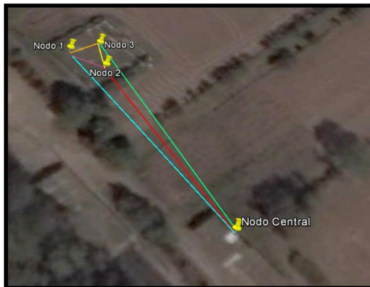
Figura 35. Ubicación del nodo central y nodos sensores en el invernadero de la granja La Pradera.
