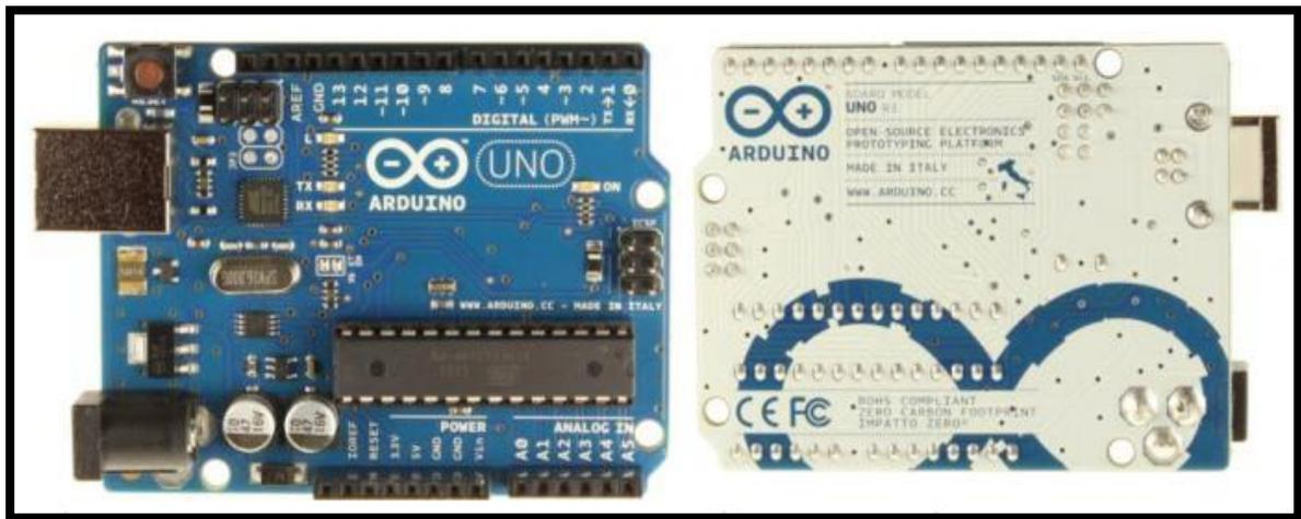
Figura 14. Placa Arduino UNO
