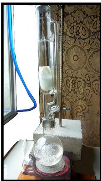
**Fotografía 7.** Extracción continua sólido-líquido en equipo soxhlet
