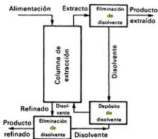
Figura 3. Extracción líquido-líquido por contacto continuo, con recuperación del disolvente.
