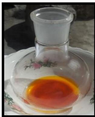
**Fotografía 8.** Evaporación del solvente acetona a temperatura ambiente (De 17 °C a 23 °C)
