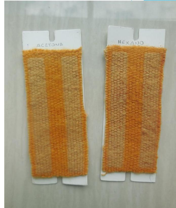
**Muestras tinturadas con colorante extraído a partir de cuerpos fructíferos con solvente acetona y hexano + 20 horas de exposición a la luz.**
