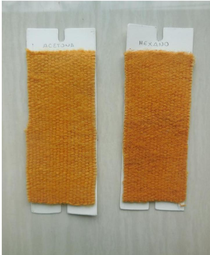
**Muestras tinturadas con colorante extraído a partir de cuerpos fructíferos con solvente acetona y hexano**
