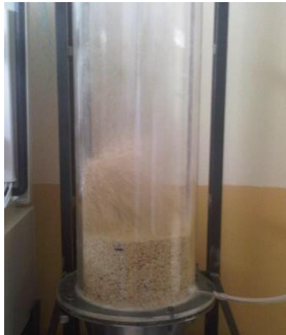
Foto 7. Secado en el reactor de fluidización.
