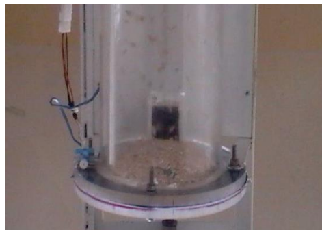
Foto 1. Partículas finas expulsadas del sistema por la velocidad de arrastre
