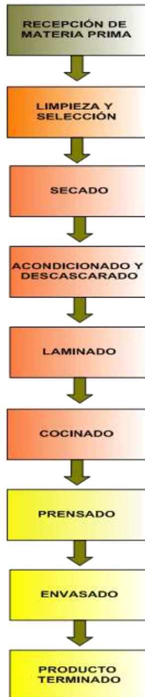
Figura 18: Diagrama de bloques del proceso de extracción de aceite crudo de girasol Elaborado por: El Autor
