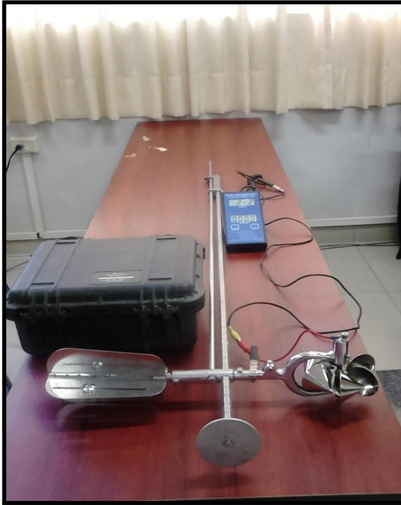
**Figura 2.1.** Molinete electrónico marca RICKLY HYDROLOGICAL
