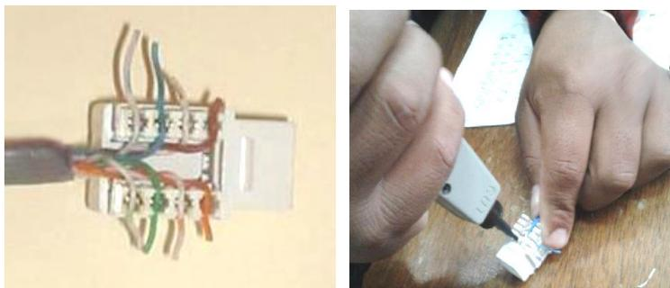
*Figura 60.* Ponchado de cable UTP con jack RJ-45. Red de datos de la Cámara de Comercio de Otavalo.
