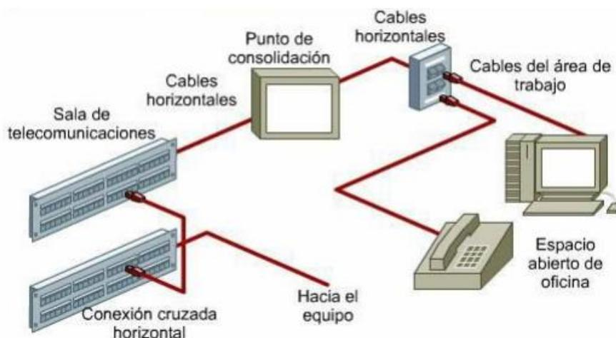
*Figura 22.* Punto de consolidación. Manual de Cableado Estructurado, 2015. Pág 275.
