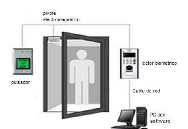
Figura 55. Diagrama de conexión hacia la puerta. TechnologiesINH, 2016.
