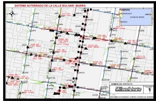
Figura 3 Sistema soterrado de la Calle Simón Bolívar
