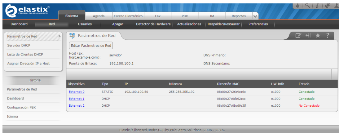
Figura 32 Imagen de los parámetros de red de la PBX Fuente: Extraído del servidor de telefonía IP.
