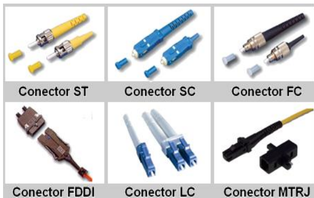
Figura 5: Tipos de conectores de fibra óptica
