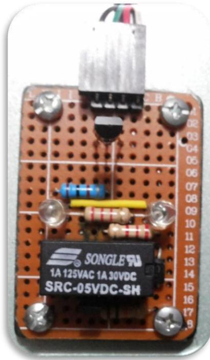
Figura 63 Diagrama pictórico del sensor de temperatura.
