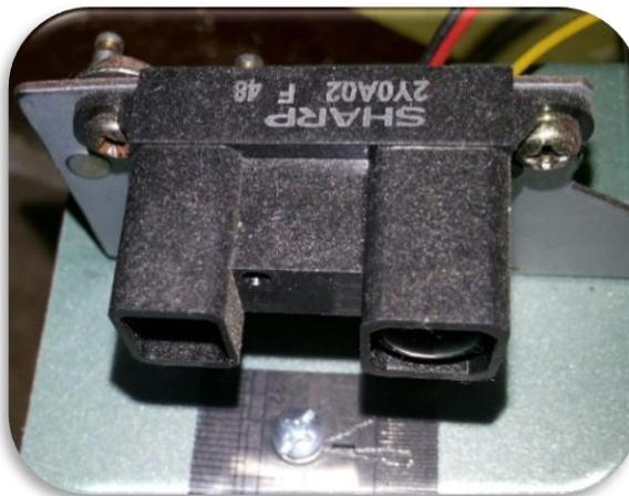
*Figura 17 Sensor infrarrojo de distancia Sharp GP2Y02YK0F.*
