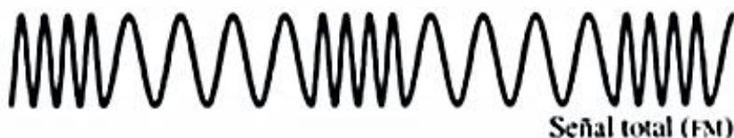
*Figura18.* Resultado de la señal FM estructurada por la portadora y la señal de audio.
