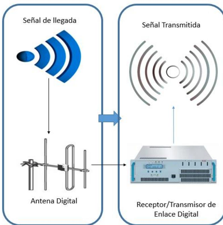
Figura 60. Esquema de Funcionamiento Canal Universitario – Sistema de Transmisión con DRM
