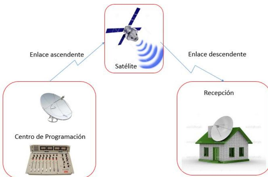
*Figura 6:* Esquema de Radiodifusión Satelital
