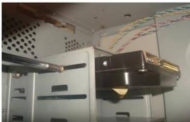
**Figura 45. Extracción de tornillos del disco duro.**
