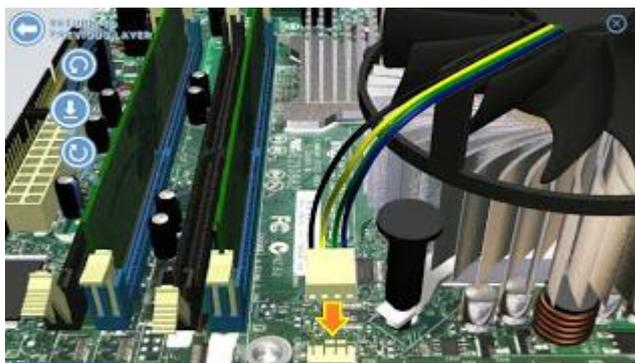
**Figura 61. Alimentación del disipador**
