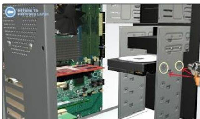
**Figura 67. Aseguramiento del disco al gabinete con tornillos**
