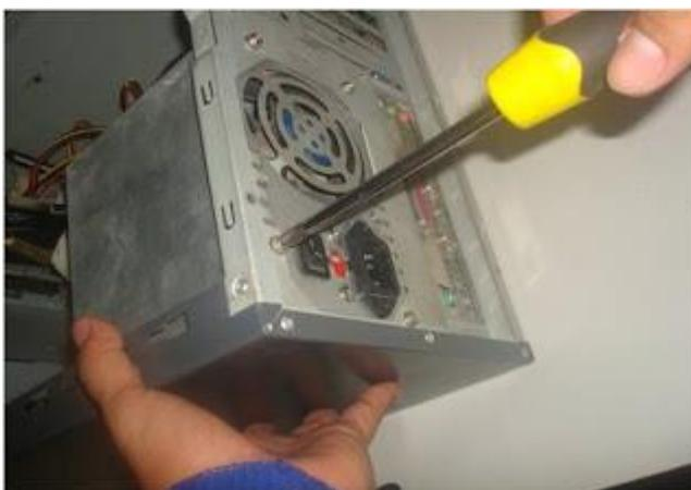
**Figura 41. Desconexión de fuente de poder**
