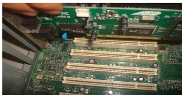
**Figura 54. Extracción de la tarjeta PCI.**
