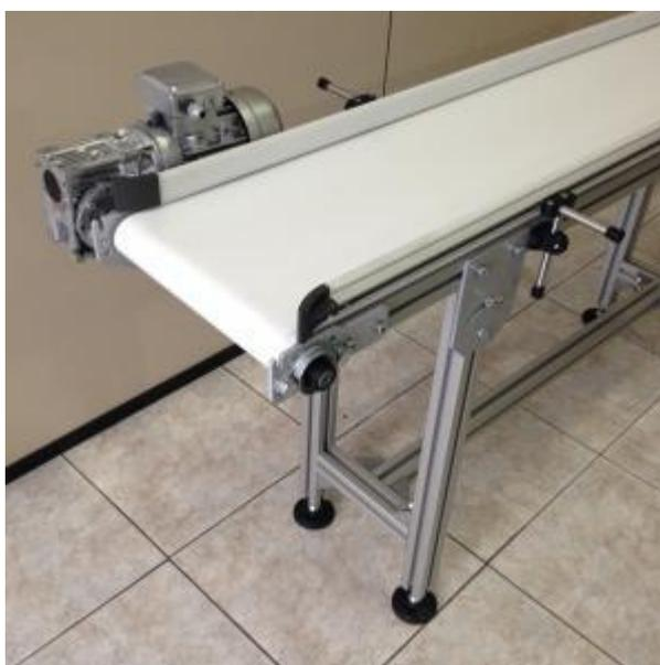
**Figura 80. Banda transportadora**
