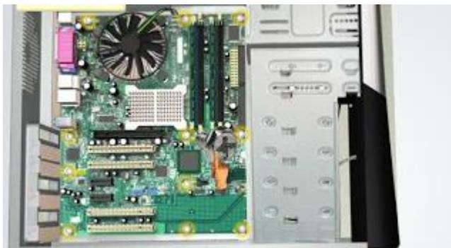
**Figura 64. Motherboard sujeta al gabinete con tornillos**
