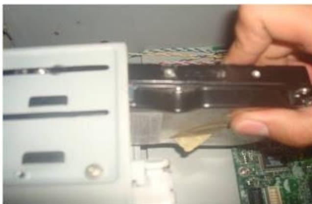
**Figura 46. Deslizamiento para la extracción del disco duro.**
