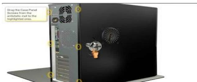
**Figura 73. Ajuste de las tapas con tornillos**
