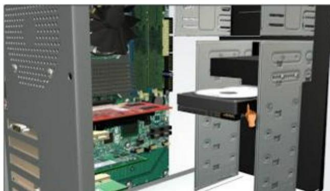
**Figura 66. Instalación de disco duro en el gabinete**
