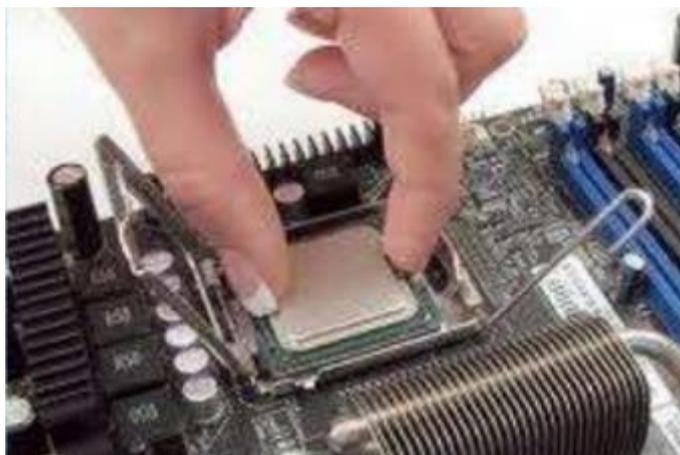
**Figura 50. Extracción del microprocesador.**
