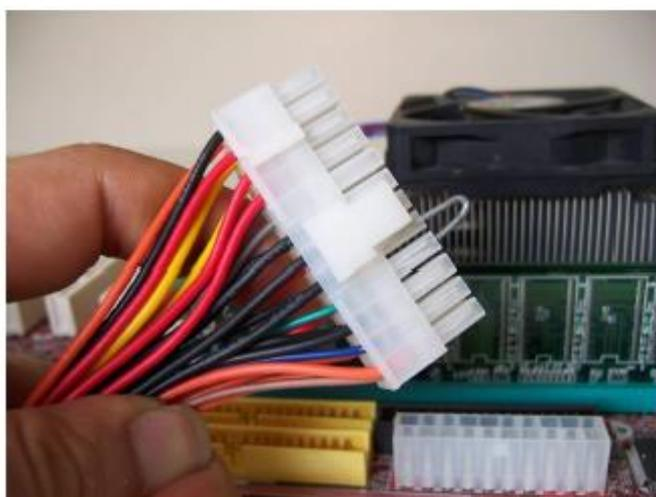
**Figura 55. Puente conector verde negro fuente ATX**
