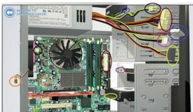
**Figura 70. Conexión de cables internos y de alimentación**
