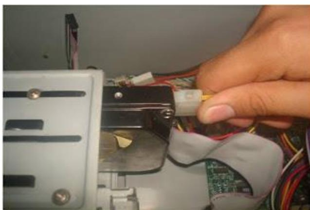
**Figura 43. Desconexión de cables del disco duro**
