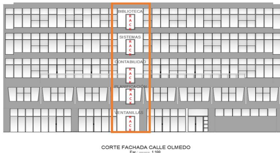
Figura 4: Disposición De Cuartos De Telecomunicaciones
