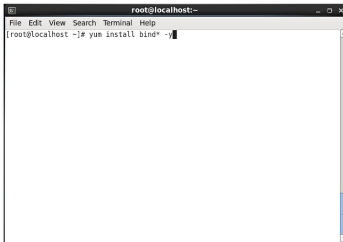
Figura 99. Instalación de bind
