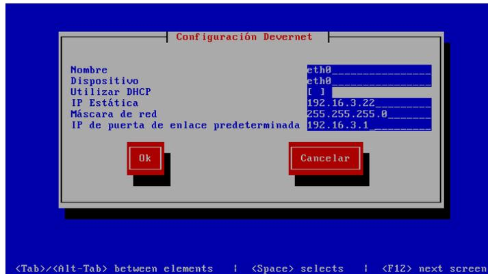
Figura D3 24. Asignación de dirección IP del servidor
