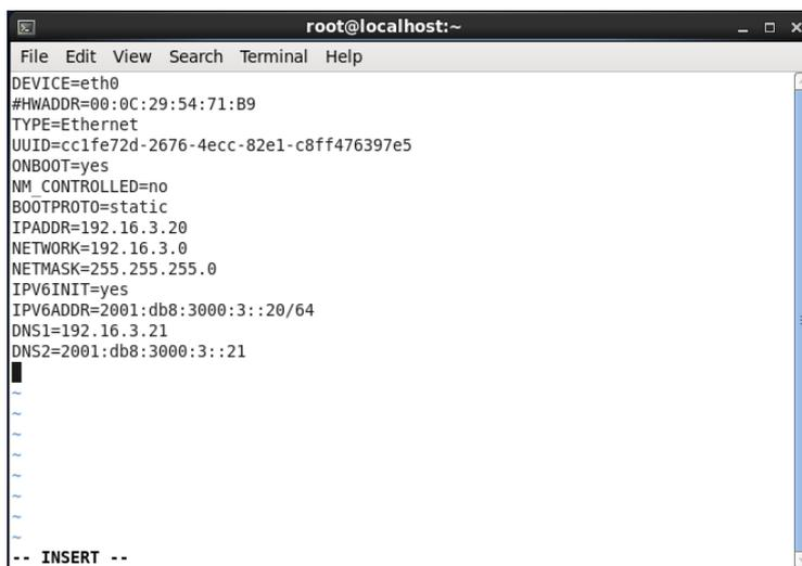
Figura 91. Agregar los parámetros en IPv4 e IPv6
