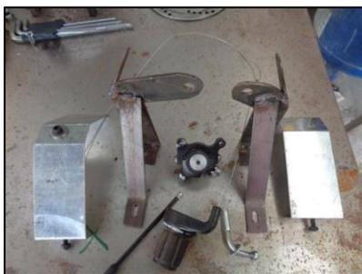
*Figura 63:* Elementos de sujeción de freno.
