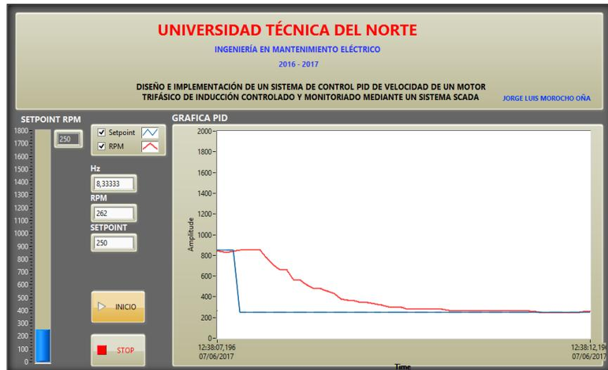
Figura 146: Recuperación del sistema Setpoint con perturbación.
