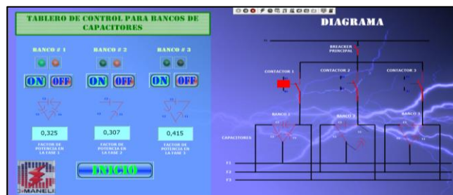
Figura 14: Factor de Potencia, Banco 1 Encendido
