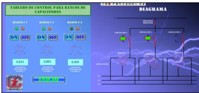
Figura 15. Factor de Potencia, Banco 2 Encendido
