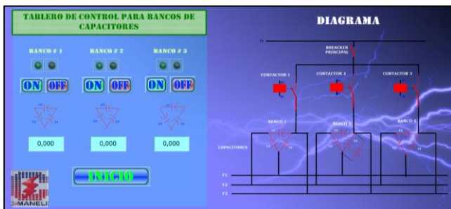
Figura 5. Control de bancos de capacitores. MOVICON 11.5
