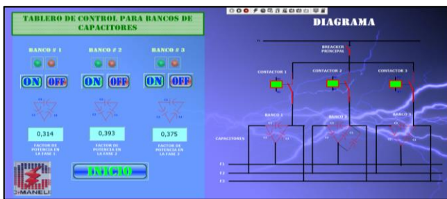
Figura 16. Factor de Potencia, Banco 3 Encendido
