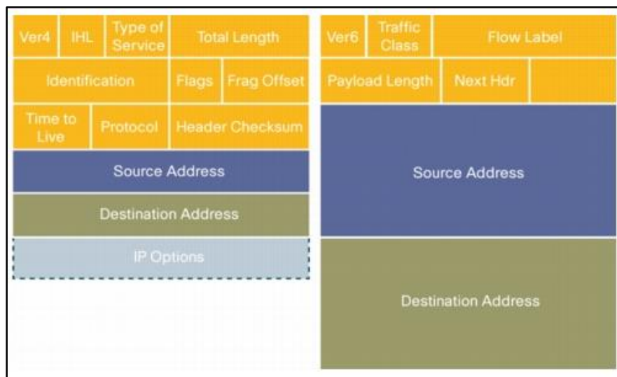
Figura 27 Cabecera IPv4 e IPv6 con Diffserv
