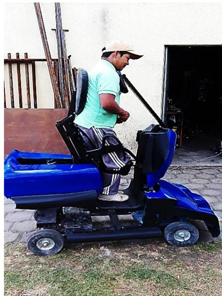
**Figura 5.7:** Ensamble completo de la silla bipedestadora
