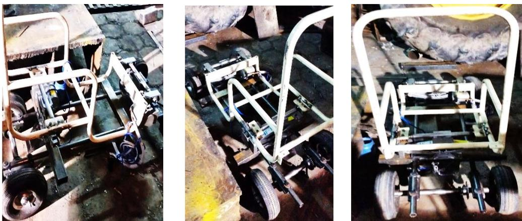
**Figura 5.4:** Construcción de la base de la silla bipedestadora.
