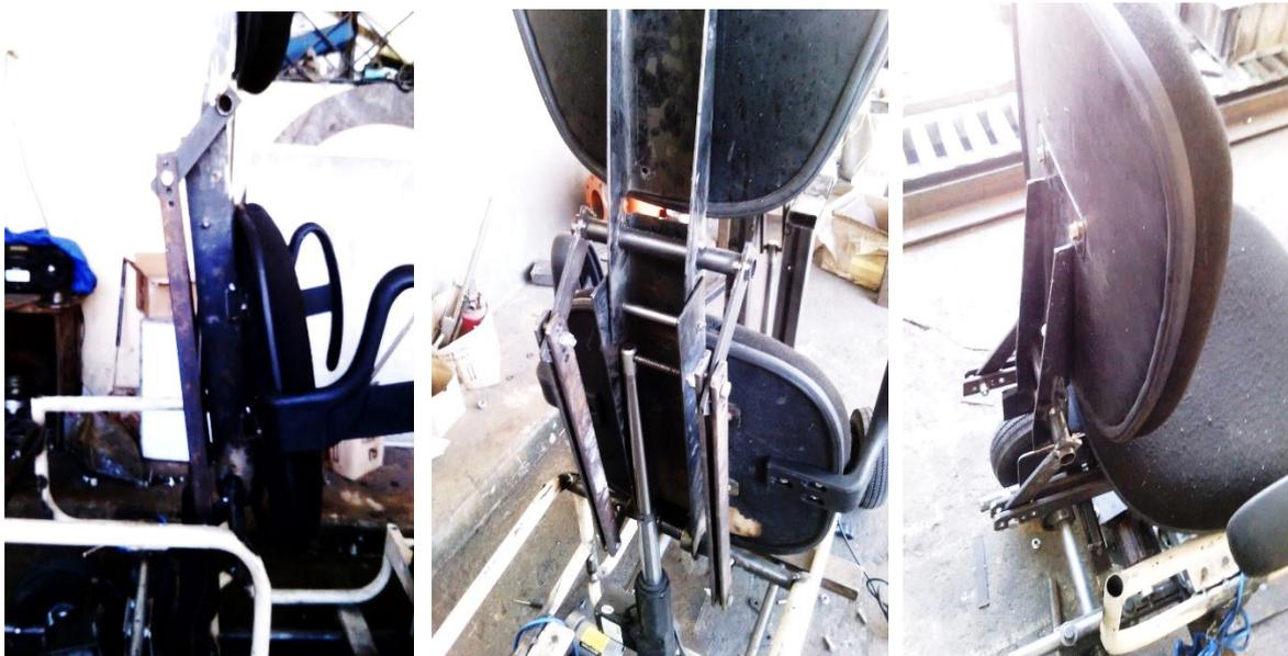
**Figura 5.2:** Construcción de las barras motrices.
