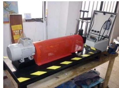
Figura 3 Máquina de fatiga terminada.
