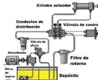
Figura 1. Sistema hidráulico [21]
