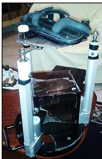
*Figura 2.3 Dispositivo de rehabilitación pasiva de lesión de tobillo.*
