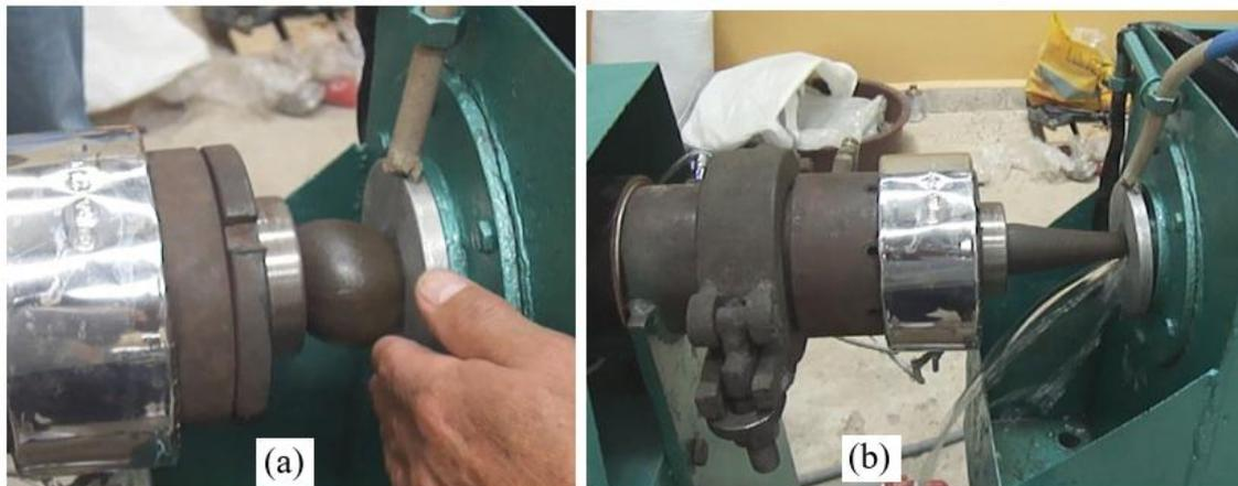
**Figura 4.5** Comportamiento del perfil extruido al variar la presión
