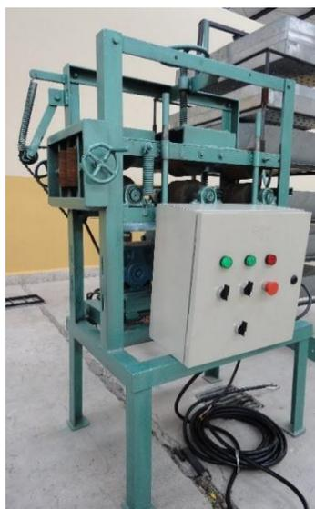
**Figura 2.8** Máquina tensora con sistema de rodillos
