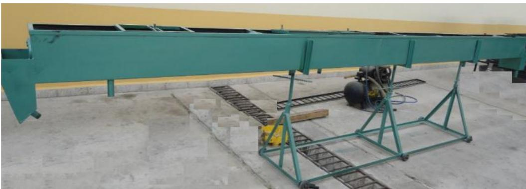
**Figura 3.10** Tina de enfriamiento para la fabricación de mangueras
