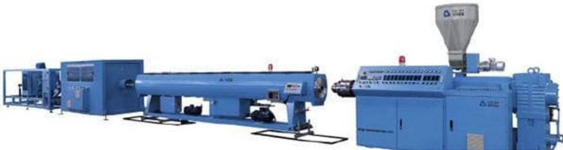
**Figura 3.1** Línea de extrusión de perfil tubular [11]
