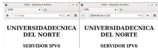
Figura 24. Prueba de funcionamiento por IP de servidor Web
