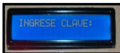
Figura 274. Visualización del pedido de clave de finalización en el dispositivo receptor.
