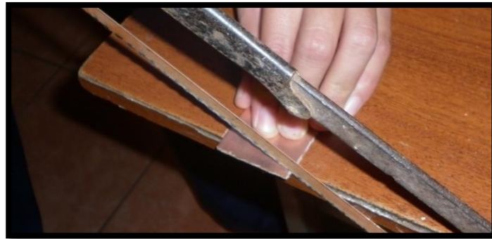
Figura 122. Recorte de la baquelita del circuito receptor.
