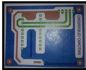
Figura 116. Impresión del circuito receptor.
