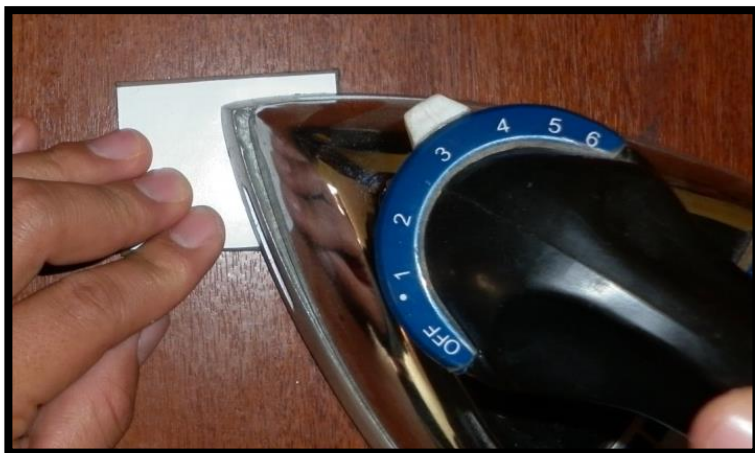
Figura 129. Impregnación del circuito transmisor en la baquelita.
