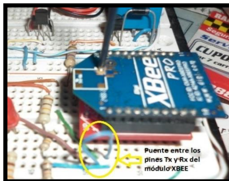
Figura 111. Puente de los pines TX y RX del módulo XBEE correspondiente al Aula 301.
