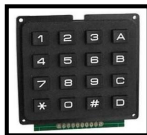
Figura 25. Estructura física del teclado matricial.
