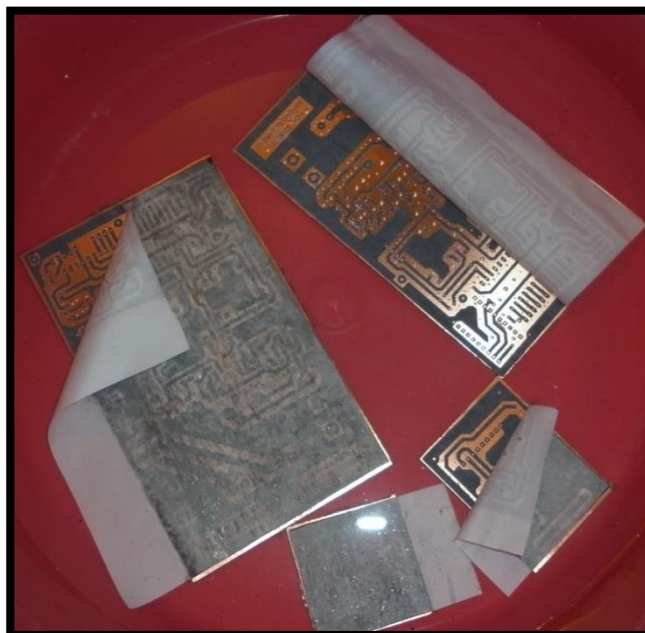
Figura 131. Desmontaje del papel de las placas en los diferentes circuitos.
