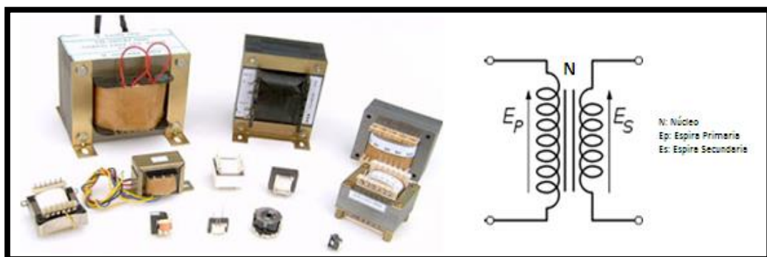
Figura 28. Estructura física y simbología del transformador.
