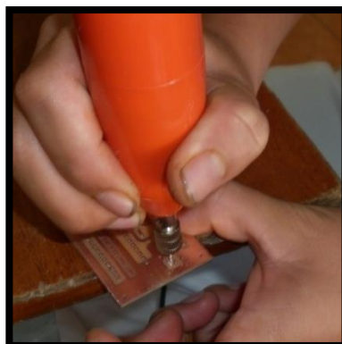
Figura 138. Perforación del circuito transmisor.
