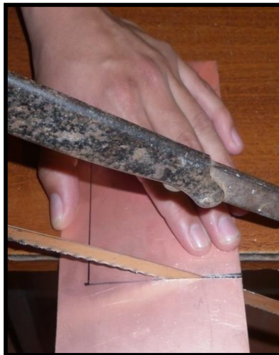
Figura 122. Recorte de la baquelita del circuito receptor.
