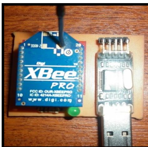
Figura 142. Circuito transmisor terminado.
