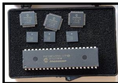
Figura 2. Microcontroladores PIC de Microchip.
