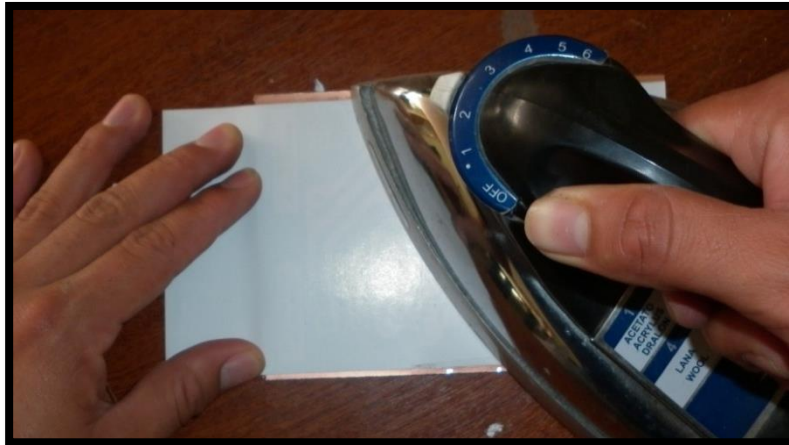
Figura 130. Impregnación del circuito receptor en la baquelita.
