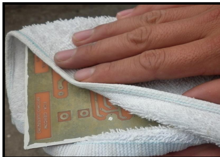
Figura 136. Secado del circuito receptor.
