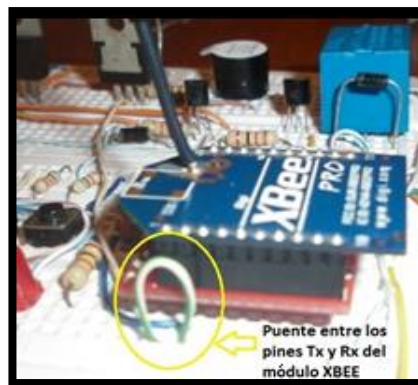
Figura 110. Puente de los pines TX y RX del módulo XBEE correspondiente al Aula 201.
