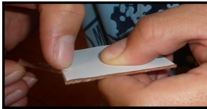
Figura 127. Ubicación de la pista impresa en la baquelita del circuito receptor.
