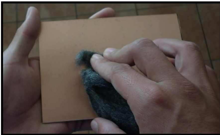
Figura 124. Lijado de la baquelita del circuito receptor.
