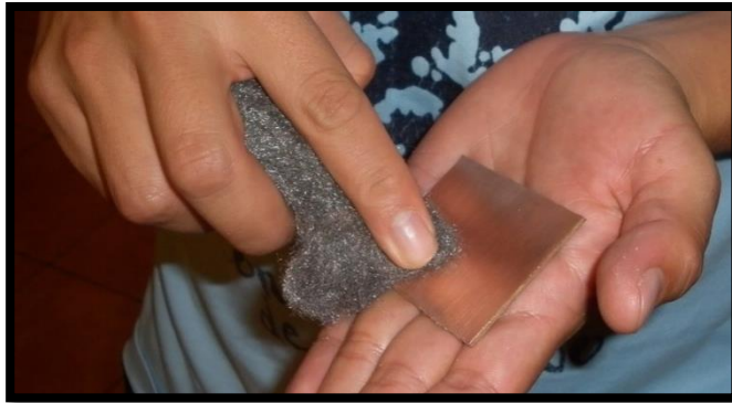
Figura 124. Lijado de la baquelita del circuito receptor.
