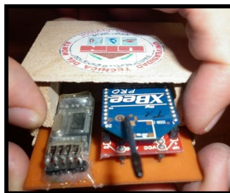
Figura 144. Ubicación del circuito transmisor en su respectiva carcasa.
