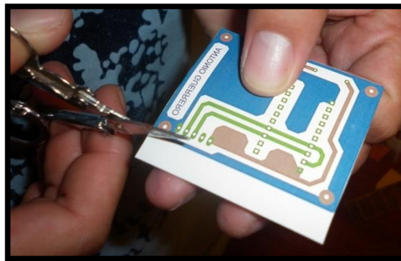
Figura 118. Recorte del circuito receptor.
