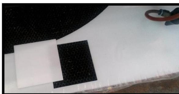
Figura 94. Corte de las caras del cubo en material acrílico
