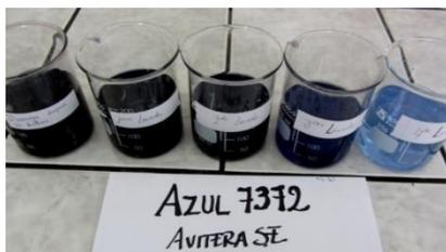
**Fig. 13.** Muestras de los baños de lavados en un color bajo y un color fuerte, tintura realizada en planta con colorantes AVITERA SE
