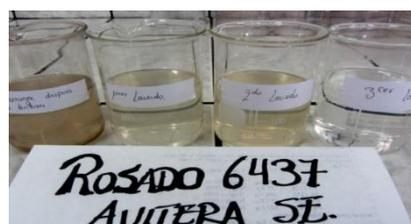
Fig. 12. Muestra comparativa del baño residual después de la tintura con colorantes NOVACRON y colorantes AVITERA SE
