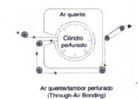
Gráfico 25 Proceso de consolidación por el pasaje de aire en un cilindro perforado
